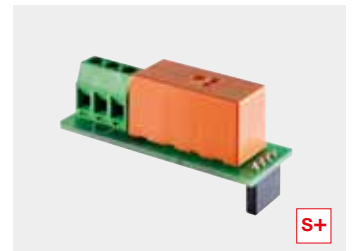
Relè extra, per accendere l'illuminazione esterna/interna insieme all'automazione. Disponibile solo per automazioni S+. (cod. SZ950) (optional)
