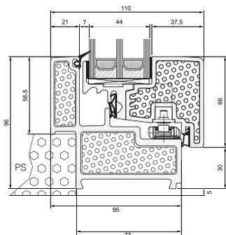
Sezione nodo telaio totalmente nascosto
